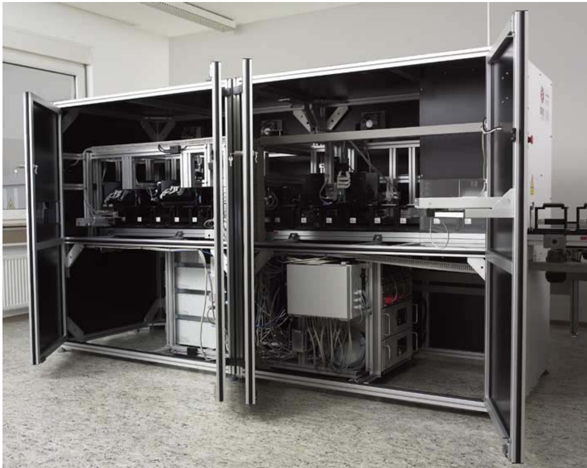
Bild 4: Inspektionsanlage für lackierte Oberschalen von Blutzuckermessgeräten. Eine Reinigungsstation ist integriert, die Zykluszeit liegt bei 2,5 Sekunden.
