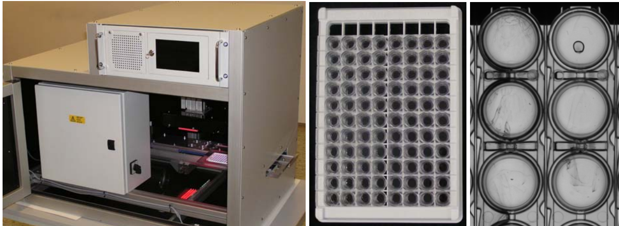
Bild 7: Links: Prüfsystem Mikrotiterplatten. Mitte: Eine Mikrotiterplatte. Rechts: Typische Fehler (Schlieren, Einschlüsse).
