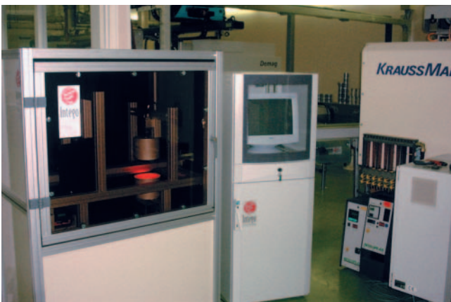
Bild 1. Das Kameraprüfsystem Opal zur automatischen Prüfung von Handy-Displaylinsen; links: Aufnahmeeinheit, Mitte: Auswertungseinheit
