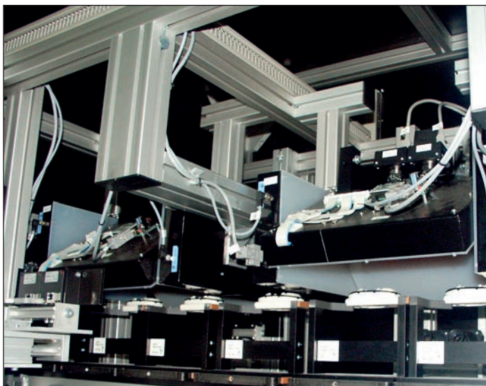
Blick in das neue Prüfsystem: Die Einzelprüfstationen enthalten optische Prüfköpfe und die zugehörigen Beleuchtungseinrichtungen sowie elektrische Verstelleinheiten zur Adaption an verschiedene Objektgeometrien.
