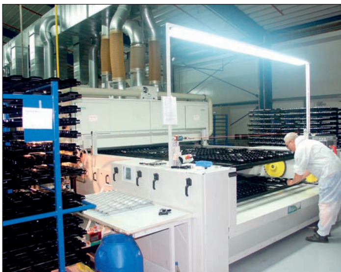
Die Bestückung der Anlage mit Lackiergut erfolgt manuell. Anschließend werden die Werkstücke mit dem Förderband kontinuierlich den einzelnen Arbeitsschritten zugeführt.
